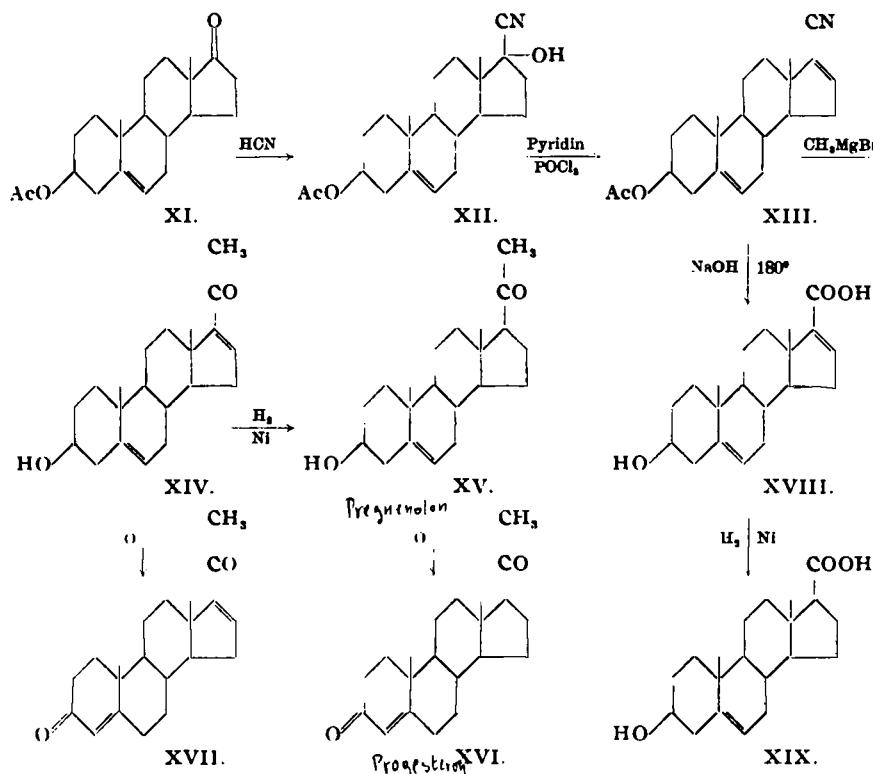
Dehydroandrosteron-acetat (XI) wird mit KCN, Eg. in Alkohol in das Cyanhydrin (XII) übergeführt. Aus diesem erhält man durch Dehydratisierung mit  $\text{POCl}_3$ , Pyridin das doppelt ungesättigte Nitril XIII. Seine Umsetzung mit  $\text{CH}_3\text{MgBr}$  führt zum doppelt ungesättigten Ketoalkohol XIV.
